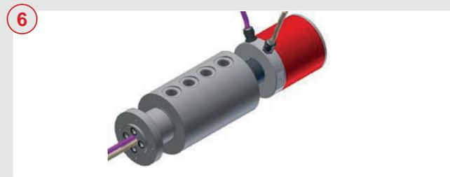
6 Anillo rozante cerrado, IP 64 con multi-transmisores para aceite hidráulico y partes eléctricas en la parte posterior. Presión hasta 500 bar.
